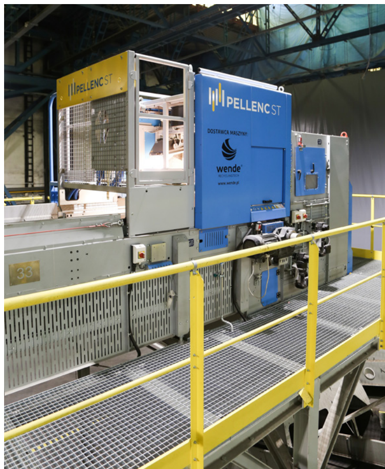
Największy zastosowany w EKOPAK optosorter Pellenc Mistral+ Connect DVI 1200 służy do wysortowywania butelek PET z podziałem na trzy kolory.
